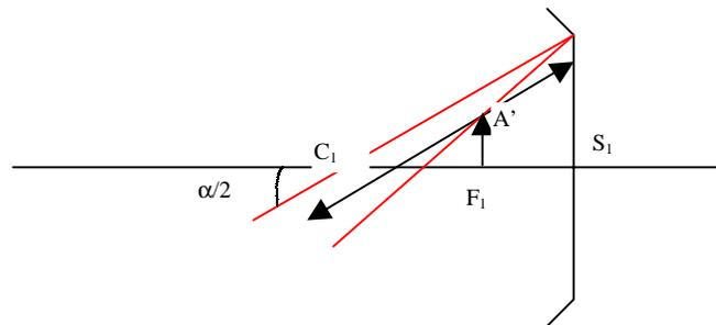
Des rayons parallèles entre eux convergent en un point du plan focal, ce point est donné par le rayon passant par le centre qui est réfléchi sur lui même.
