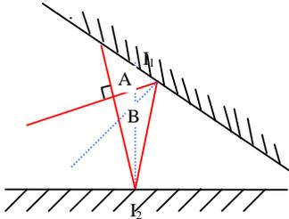
Dans le triangle  $BI_1I_2$  :  $BI_1I_2 + BI_2I_1 = 45^\circ$ , propriétés dans le triangle : les normales étant perpendiculaires au miroir, elles font entre elles un angle de  $45^\circ$ .
