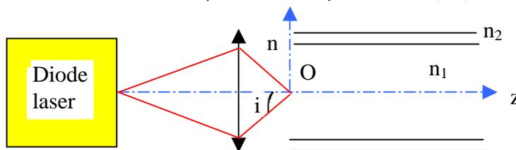
b) Une impulsion lumineuse arrive à  $t = 0$  au point O sous la forme d'un faisceau conique convergent de demi-angle au sommet  $i$  avec  $i < i_m$ .
